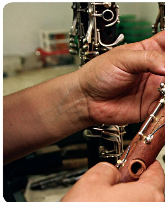
e deixá-la secar, naturalmente, injetando parafina de vela ou silicone ou aplicando raio laser, para não deixar a madeira empenar. Depois, é feita a usinagem no torno e as furações, realizadas com máquinas automáticas, com uma tecnologia computadorizada muito cara.
