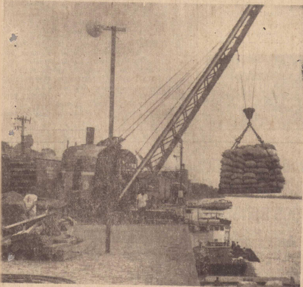
Os velhos guindastes da Fepasa funcionam há mais de vinte anos e são movidos a vapor com produção mínima.
