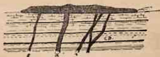
Fig. 89. — Filons ayant amené à la surface du sol une roche qui s'y est étendue.
