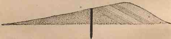
Fig. 67. — Le sable continue à s'accumuler au delà de l'obstacle.
