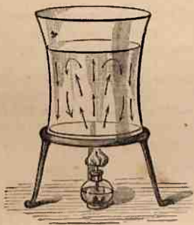
Fig. 41. — L'eau, chauffée par la lampe à alcool, monte au milieu du vase ; l'eau de la surface, qui est plus froide, redescend sur les bords.
