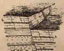
Fig. 85. — Coupe d'une faille . les terrains de droite se sont affaïsés.
