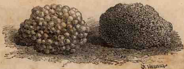
Fig. 68. — Fragments de calcaire oolilique, c'est-à-dire formé de petites boules calcaires, soudées entre elles par un ciment calcaire.
