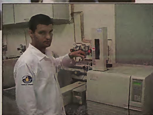
Flumignan utiliza o cromatógrafo para verificar qualidade de combustível
