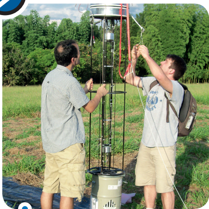
LIDAR Equipamento mede concentração de gases-estufa, como CO 2 e metano
