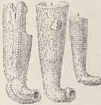
Fig. 65. — Tuyères de fours métallurgiques. — 1, Silésie. — 2 3, Hongrie.
