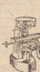
Fresadora Universal FU-1, com mesa giratória, avanço longitudinal automático e 6 velocidades.
