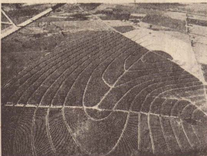
Graças ao incentivo da Prefeitura de Votuporanga multiplicaram-se os terraceamentos em curva de nível naquele município.
