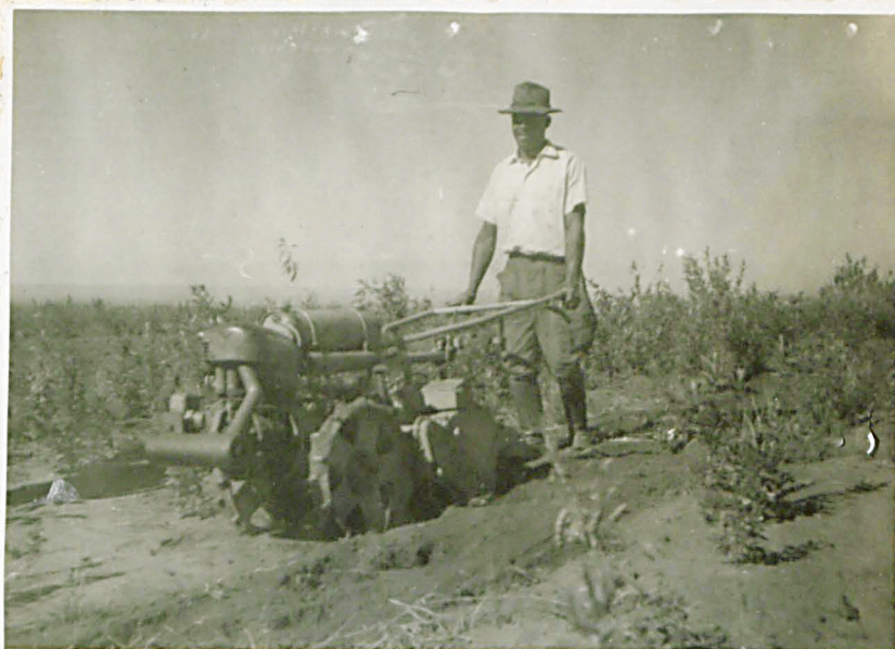
Enxada rotativa mecânica do Fomento Agri- cola do Estado, em demonstração na E.E.B.
