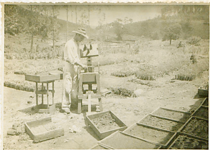
Fabricação de vasos de terra (torão Paulista) para repicagem de eucaliptos.
