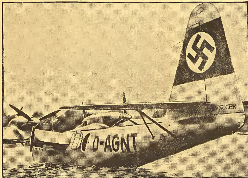
Die neue Dornier-Maschine für den Nordatlantik. — Von Travemünde kommend traf auf dem Müggelsee in Berlin das neue Atlantik-Flugboot der Deutschen Lufthansa „Do 26“, ein, das in erster Linie für den Postverkehr auf der Strecke Lissabon—Newyork im Ohnehaltflug gebaut ist. Das Flugboot hat eine Höchstgeschwindigkeit von 335 Stundenkilometer und einen grössten Flugbereich von neuntausend Kilometer. Es hat dreissig Meter Spannweite und ist mit vier Junkers-Jumo-Diesel-Motoren ausgerüstet.
