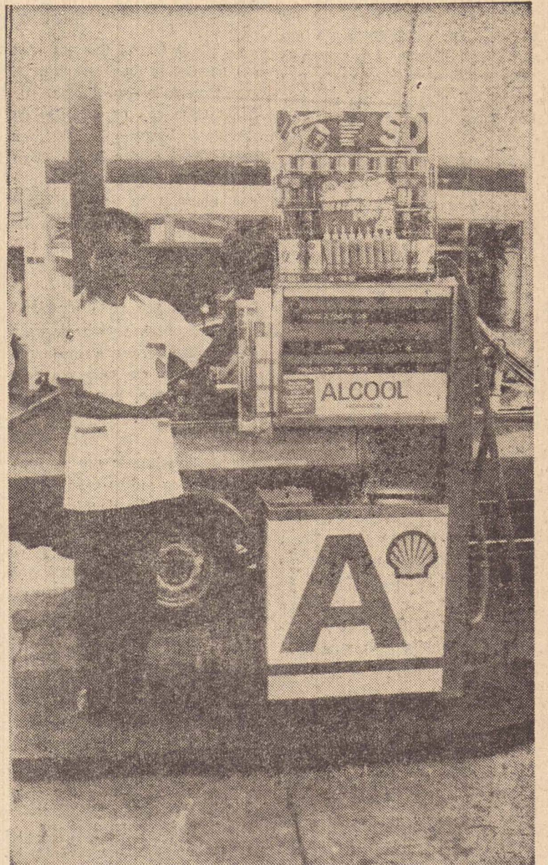
O densímetro fica acoplado a bomba de álcool e é bem visível (foto no Posto Ridson)
