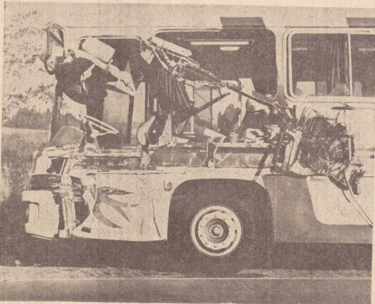
A tampa lateral da carroceria do caminhão penetrou no interior do ônibus
