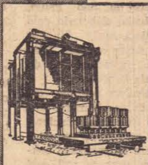
FÔRNO ELÉTRICO DE MALEABILIZAÇÃO Representa a forma mais controlada de maleabilizar o ferro.
