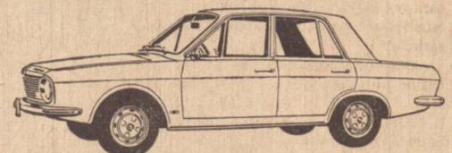
Venha visitar-nos. O Ford Corcel tem tração dianteira, radiador selado, cinco marchas, resistência, conforto para 5 pessoas, freio a disco, suspensão superdimensionada, motor dianteiro de 68 HP a 5.200 rpm (SAE), amplo porta-malas e economia — faz até 12 km com um litro de gasolina e só exige troca de óleo após cada 5.000 km rodados.
