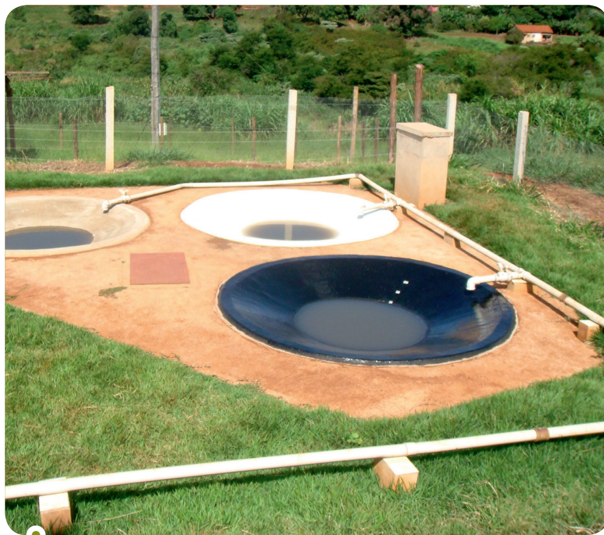
REATOR MULTICOLOR Experimento também avaliou se cores dos reatores poderiam influenciar na ação antibactericida dos raios UV, mas não houve diferenças importantes
