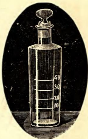
Fig. 26. — Flacon hydrotimétrique.
